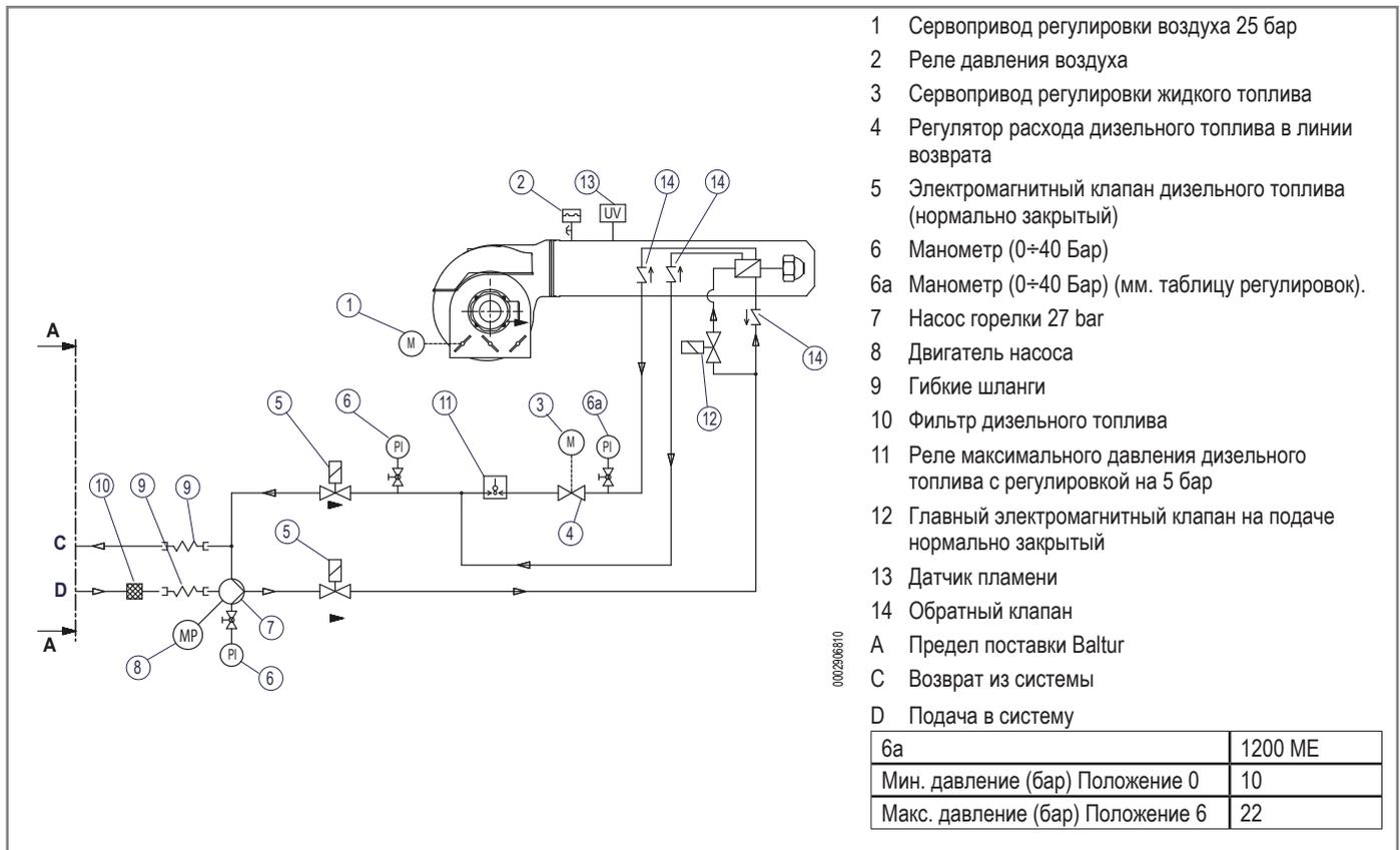
В некоторых случаях (избыточное расстояние или перепад уровня) необходимо предусмотреть установку с "кольцевой" системой питания со вспомогательным насосом, для того, чтобы избежать прямого соединения насоса горелки с баком.
